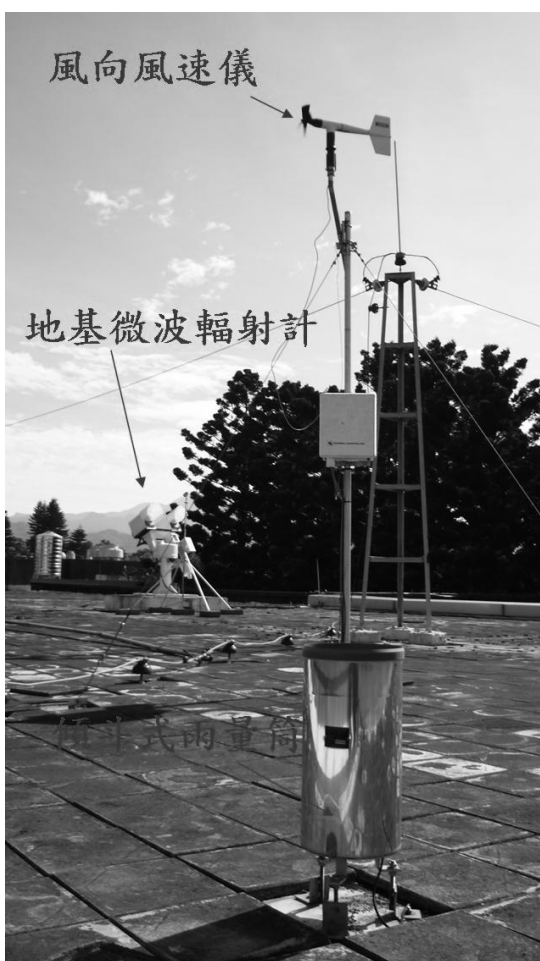
圖 3 設置於國防大學理工學院之(a)傾斗式雨量計，(b)地基微波輻射計，(c)氣象自動觀測系統之風速風向儀
